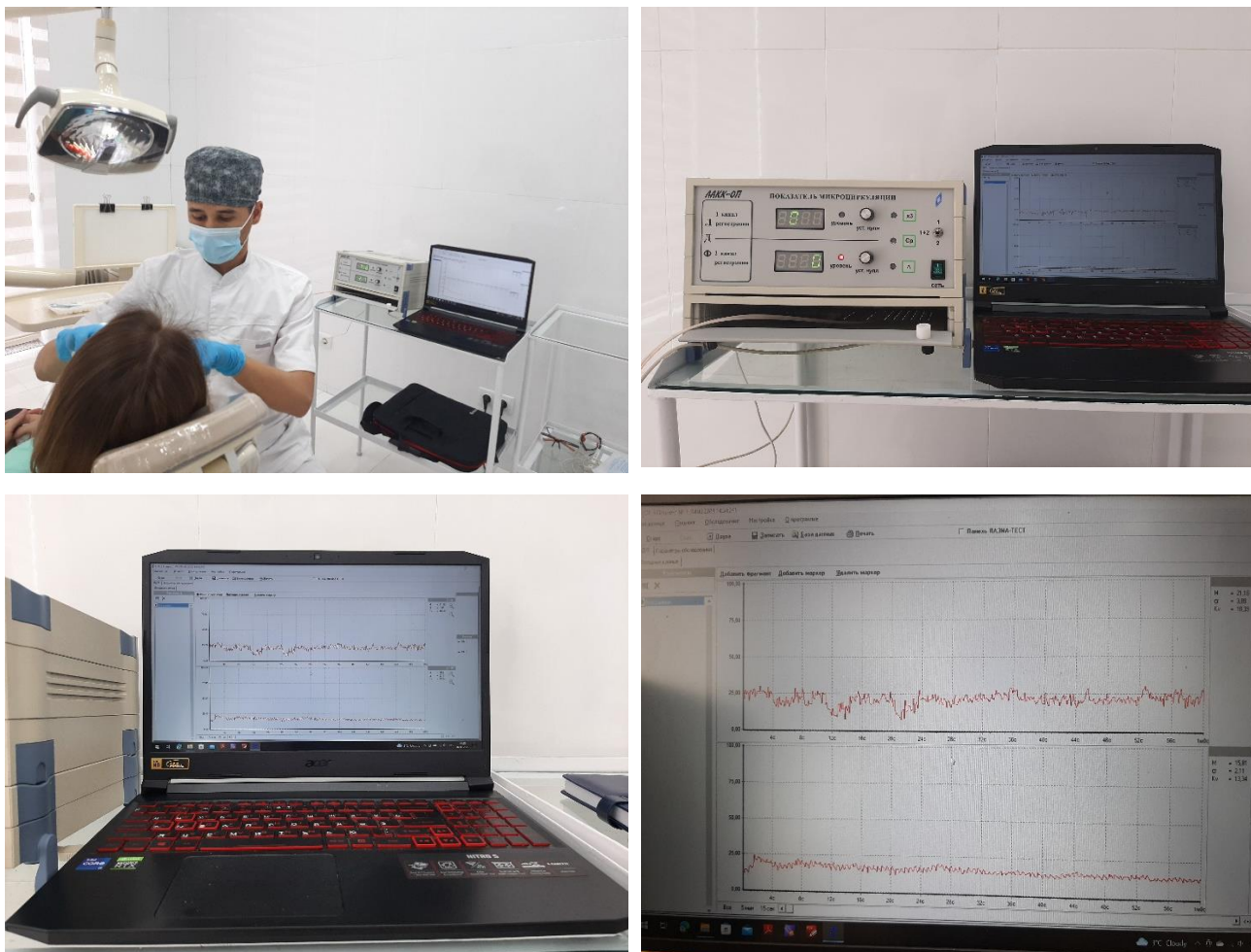
Рисунок 2.11. - Проведение метода ЛДФ и получение обработанных данных параметра микроциркуляции сосудов, с помощью программного обеспечения на персональном компьютере
