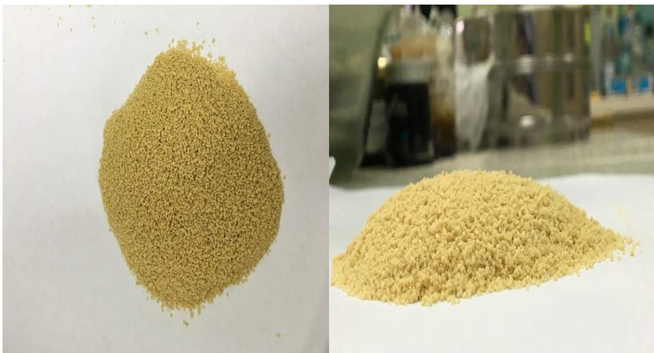
Рисунок 4.5. - Гранулы, полученные при помощи 5% раствора бентонит в спирте этиловом 50%.
