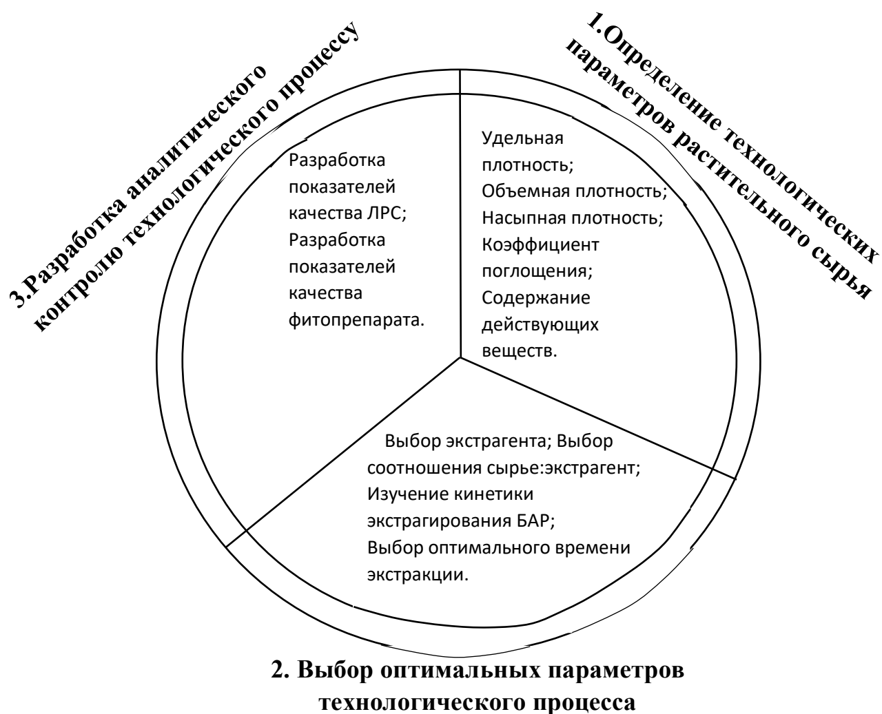
Рисунок 3.2. - Алгоритм разработки технологии экстракционных препаратов
