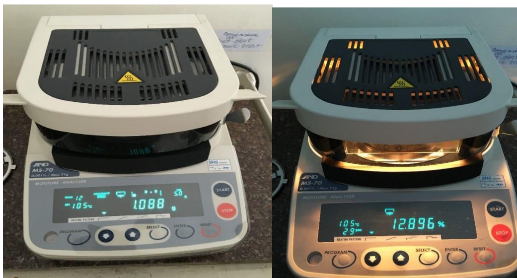
Рисунок 4.3. - Экспрессном термогравиметрическом влагомере AND MS – фирмы «MOISTURE ANALYZER» (Германия)
