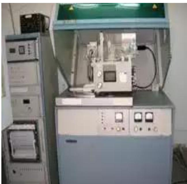
**Рисунок 7. - Рентгеновский дифрактометр ДРОН-3.0 Производитель НПО «Буревестник»**
